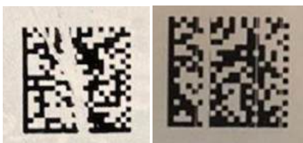
Нарушение целостности КМ*
