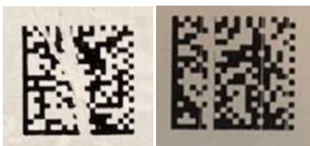
Нарушение целостности КМ*
